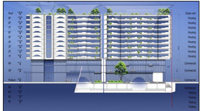
FIGURE 58 : FONCTIONNEMENT DU TOUR
