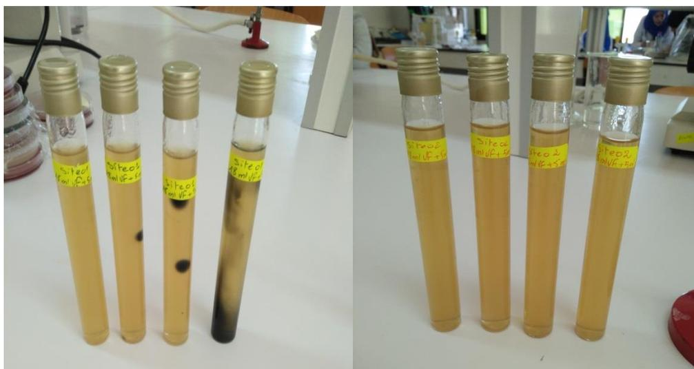
**Figure 47 :** Photos des résultats des ASR dans les eaux du Barrage de Hammam Debagh. (Photos prise par DJEDADOUA, 2017).
