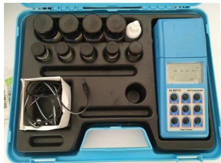
**Figure 7:** Turbidimètre (Fast Tracker, HI 98713) (**Photo prise par DJEDADOUA, 2017**).
