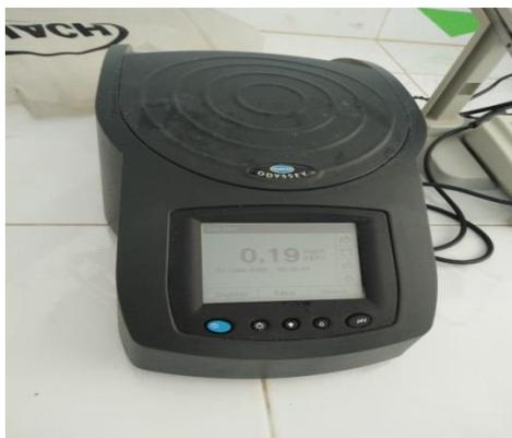
**Figure 13:** Spectrophotomètre (HACH ODYSSEY).
