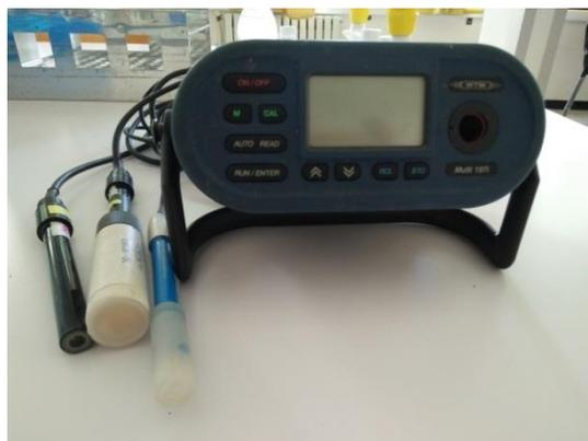
**Figure 9** : Multi-paramètre (WTW multi, 197i)
