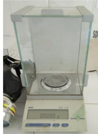
**Figure 11 :** Balance de précision mettler
