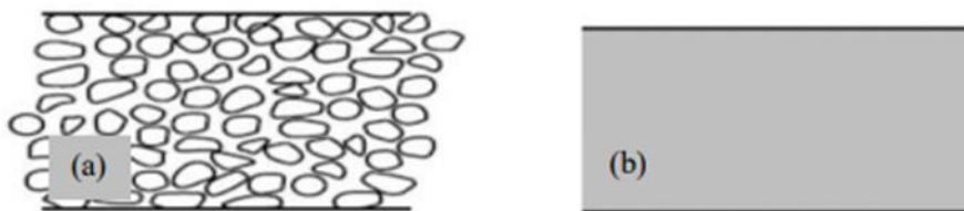
Figure.I.13: Schéma représentatif des membranes symétriques : (a) membrane symétrique microporeuse (b) membrane symétrique dense
