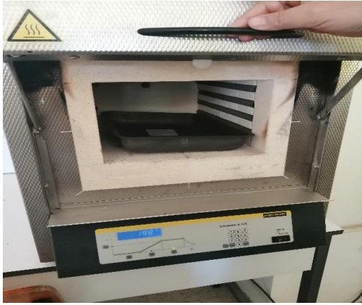
Figure.II.7: Le four de calcination des membranes
