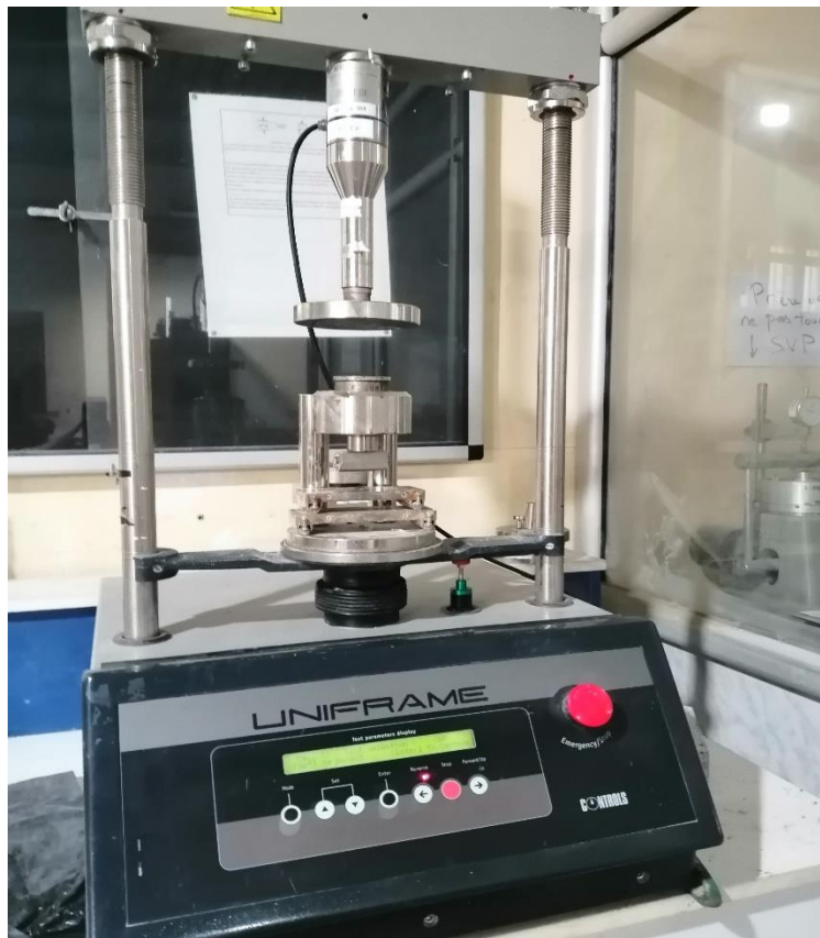
Figure.II.11: Appareil pour mesure la résistance à la flexion 3 points
