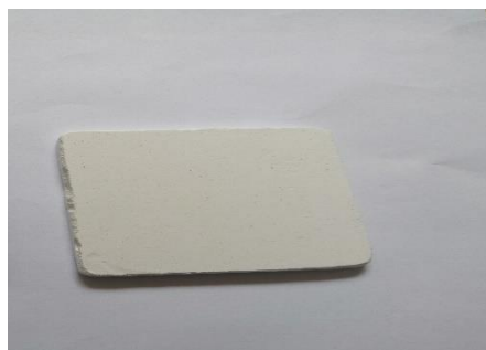
Figure.IV.10: Photos de membranes après frittage
