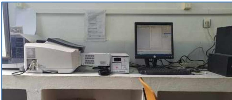
**Figure 4.7.** Spectrophotomètre UV-Visible à double faisceau Shimadzu model UV1800 utilisé.
