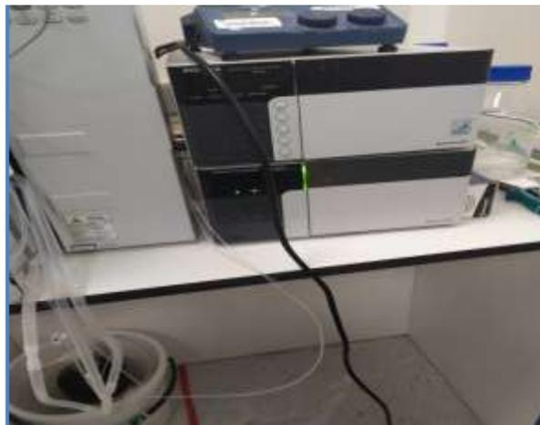
**Figure 2.2.** Chromatographe liquide à haute performance (HPLC) utilisé.
