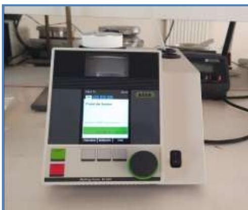
Figure 4.5. Appareil Point de fusion M-560 BUCHI utilisé.
