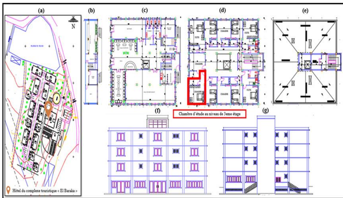
Fig. 61 : (a) situation d'hôtel sur le plan de masse du complexe touristique ; (b) plan du sous-sol ; (c) plan du RDC ; (d) plan du 1er, 2eme et 3eme étage ; (e) plan de la terrasse ; (f) façade principale ; (g) façade postérieure
