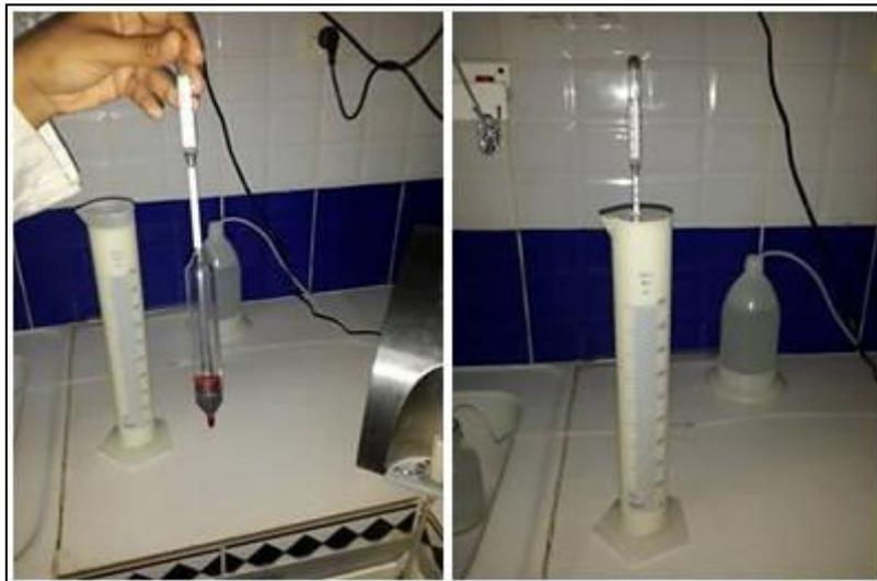
**Figure 12** : Mesure de densité du lait par le thermo-lactodensimètre.
