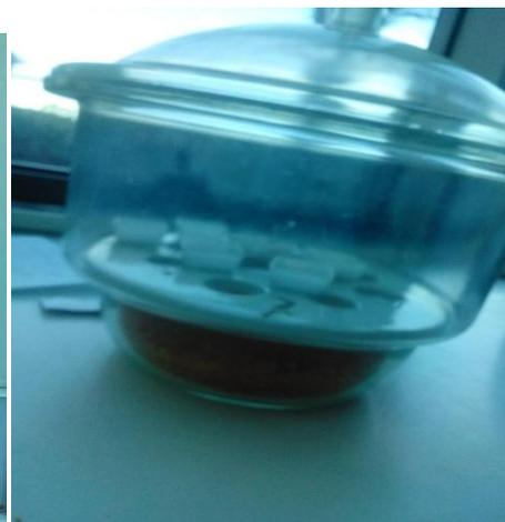
Retirer les nacelles et laisser refroidir dans le dessiccateur pendant 45 minutes, Aspect des cendres après 'incinération et refroidissement
