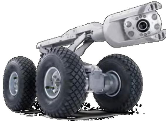
**Figure A.4 :** T 76 avec raccordement de caméra CB3, ARGUS 5 et pantographe électrique. [30]
