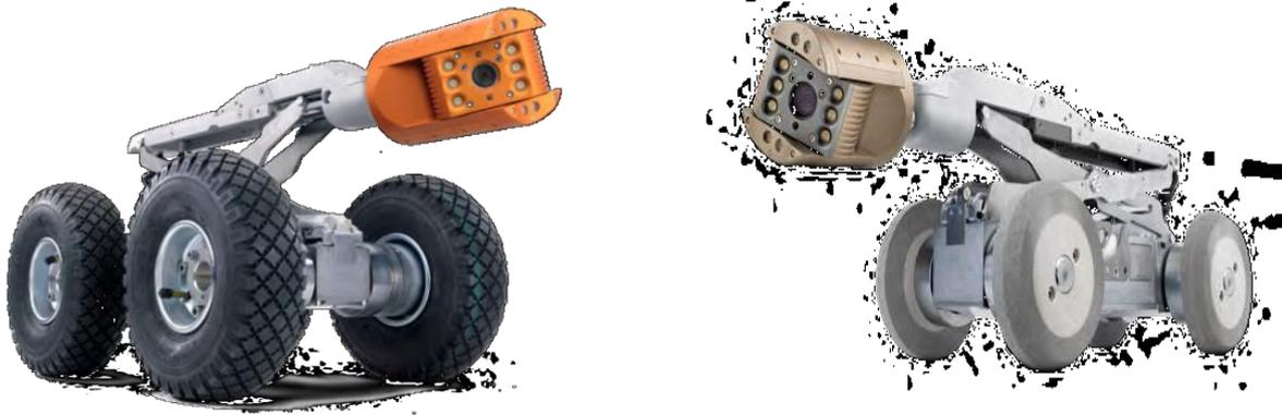
**Figure A.1 :** Caméra type ibak t 76 / t 76 hd chariot porte-caméra utilisable à partir du dn 150. [30]
