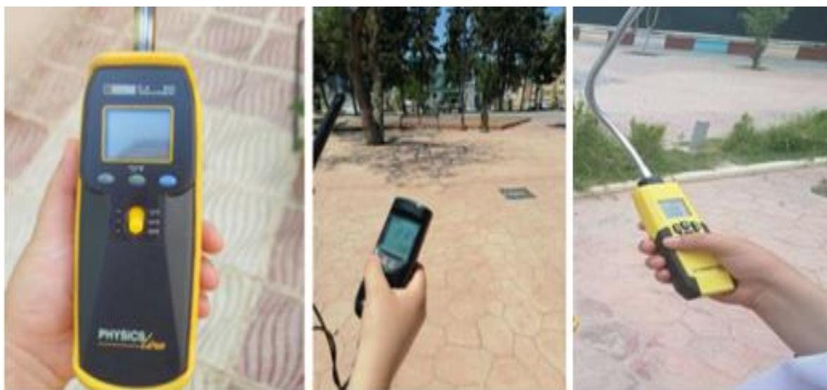
*Figure V.19: Thermomètre hygromètre Chauvin Arnoux, centre : Le thermo hygromètre portatif HANNA, droite : l'anémomètre TROTEC à hélice ba16. Source : auteur 2024.*
