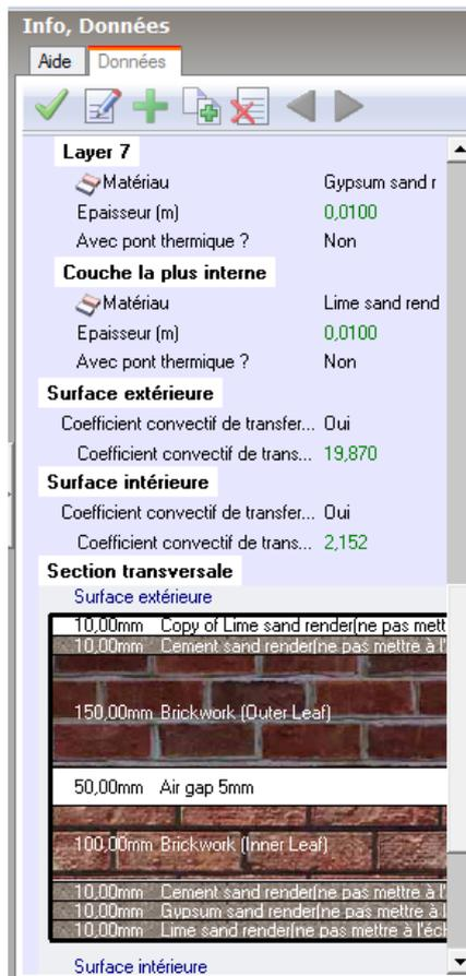
Figure 112: composants de mur extérieur à l'état actuel (Source auteur par Design Builder)
