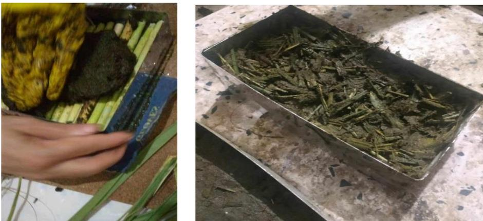
Figure 96 : moulage des éprouvettes dans les modèles en aluminium (Source, auteur, 2023)
