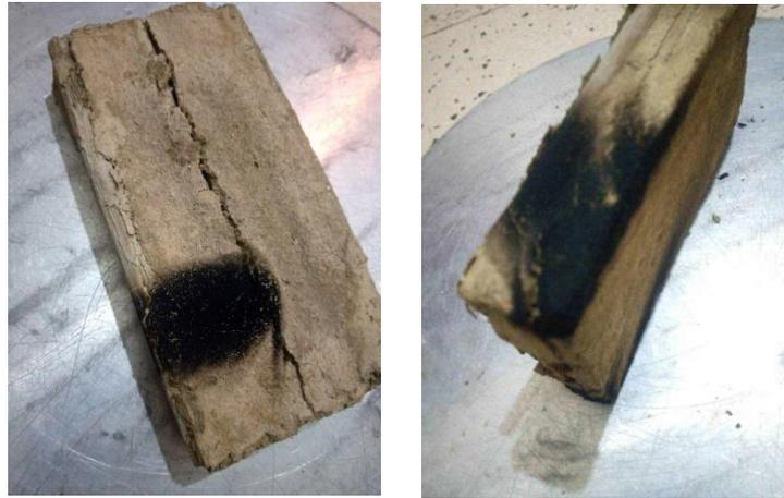
Figure 151: Résultats des essais d'allumabilité et à la résistance au feu par surface et tranche ( source: auteur, 2023)
