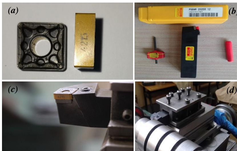
Figure II.4 Outil de coupe, porte outil et plaquette.
