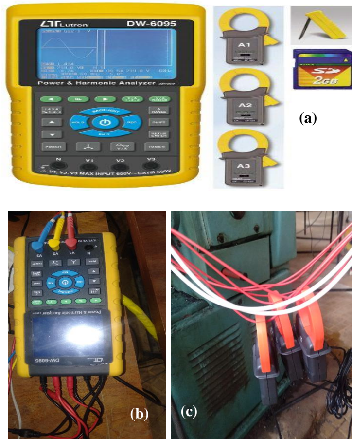
Figure II.8 Mesure de la puissance par analyseur Lutron type DW- 6095.
