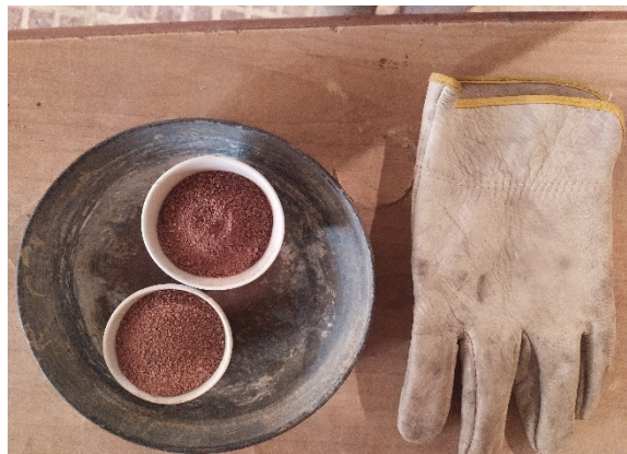
Figure II. 18 Échantillon du sol après la calcination.
