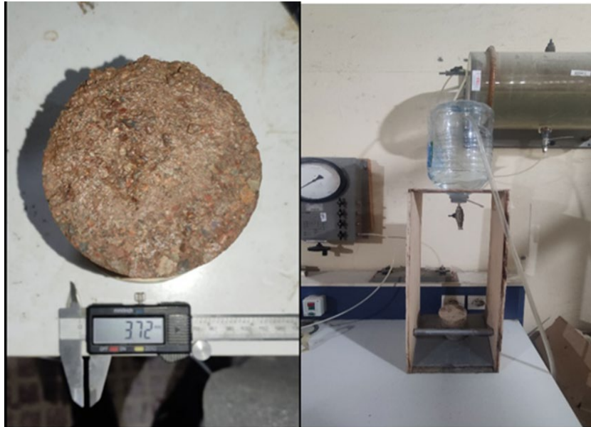
Figure II. 25 Vue générale de l'équipement pour le test d'érosion par goutte.
