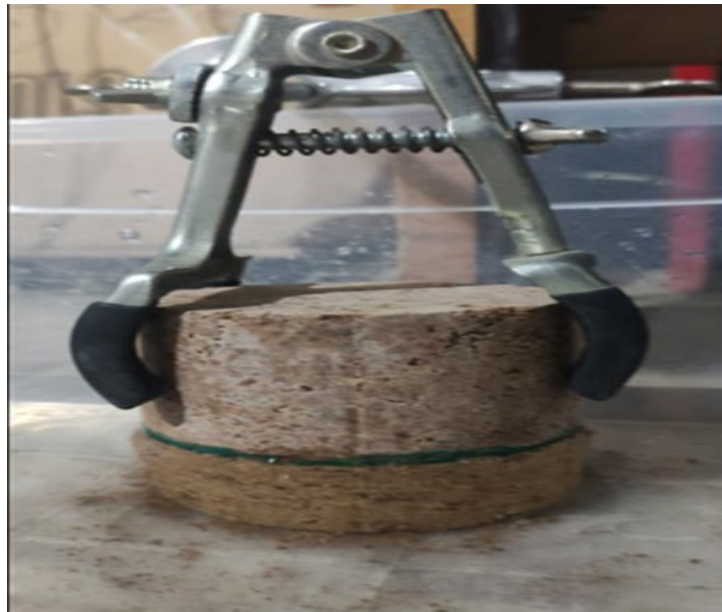
Figure II. 26 Configuration de test pour les essais d'immersion.
