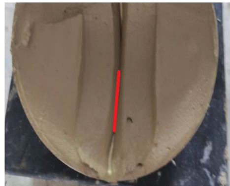
Figure II. 12 Sol se referme sur une longueur de 13 mm après être tombé plusieurs fois
