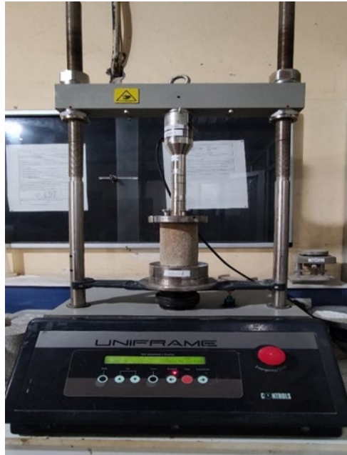
Figure II. 23 Essai de compression non-confiné sur un éprouvette cylindrique.
