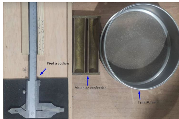
Figure II. 13 Matériel utilisé dans l'essai de Limite de Retrait linéaire.
