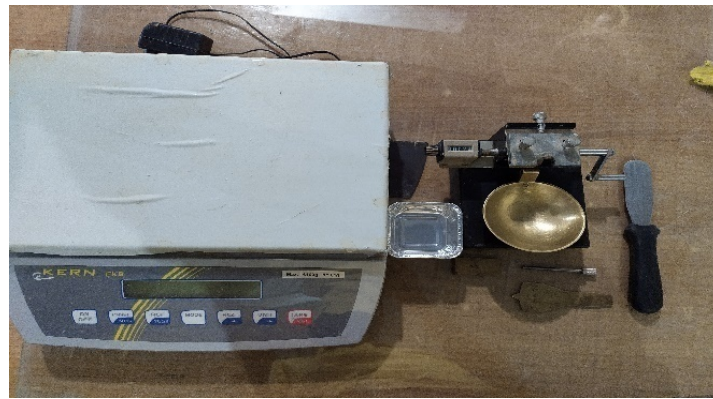
Figure II. 10 Matériel utilisé dans l'essai de Limite de liquidité.
