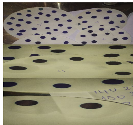
Figure II. 16 Taches de bleu de méthylène.
