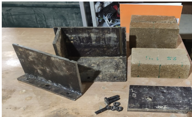
Figure II. 22 Les éprouvettes parallélépipédiques et le moule de confection
