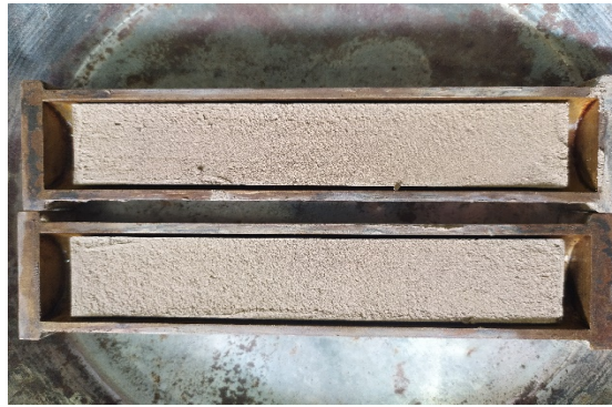
Figure II. 14 Échantillon de limite de retrait Après avoir atteint la limite de retrait linéaire maximale.
