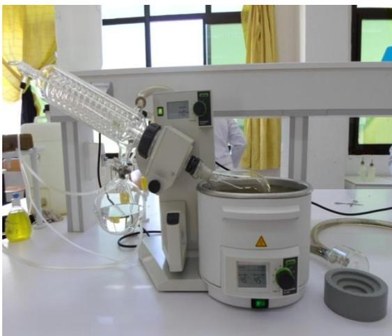
**Figure 6 :** Photographie d'un Rot à vapeur
