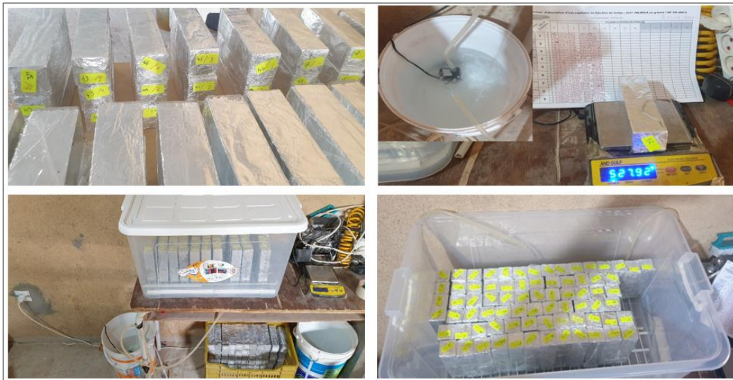
Figure III-24 : Dispositif expérimental d'absorption d'eau par capillarité.
