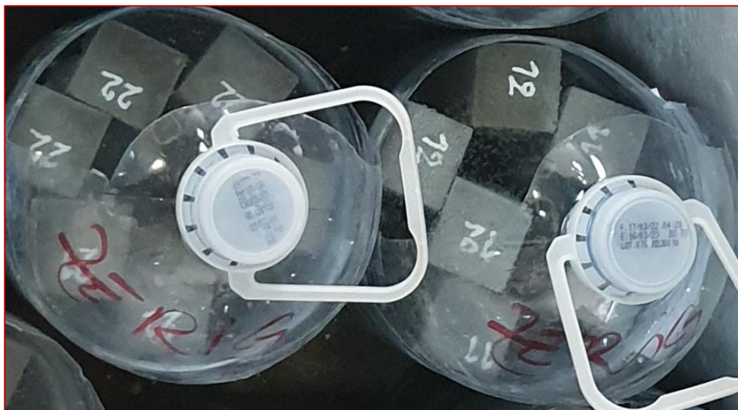
Figure III-25 : Principe expérimental d'absorption d'eau.
