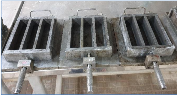
Figure III-10 : Lubrification de moule à l'huile.
