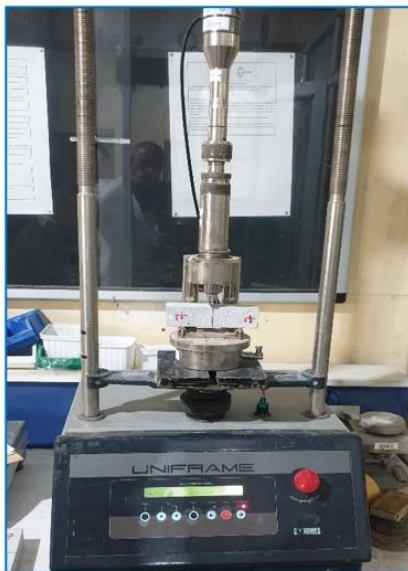
Figure III-18 : Matériels utilisés et essai de traction par flexion trois points.
