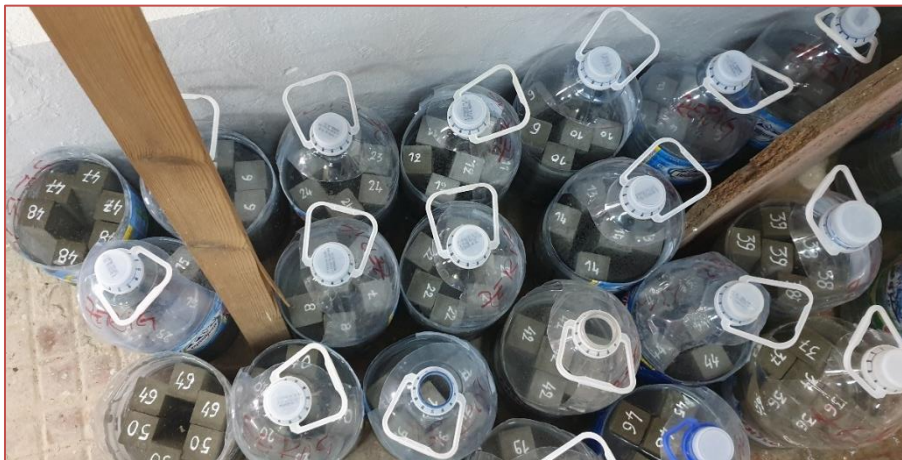
Figure III-12 : Conservation des échantillons d'essai dans l'eau.
