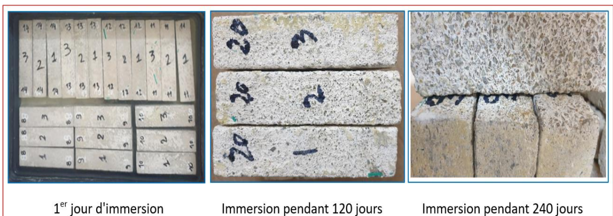
Figure IV-25 Apparence extérieure des mortiers élaborés, a) mortier témoin, b) mortier fibré.
