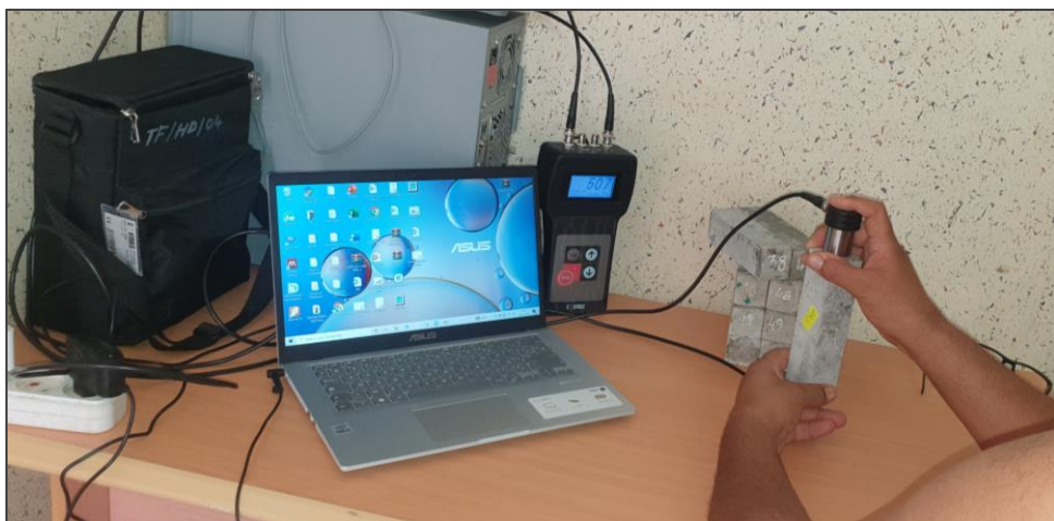
Figure III-16 : Mesure de la vitesse d'impulsion ultrasonique
