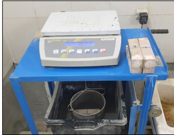
Figure III-14 : Pesage hydrostatique des éprouvettes (4x4x16) cm 3 (Sèche, humide et sous l'eau).
