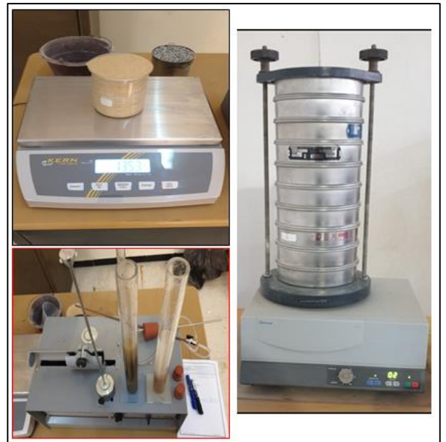
Figure III-5 : Mesure de la masse volumique des granulats, l'équivalent de sable et tamisage mécanique des granulats.
