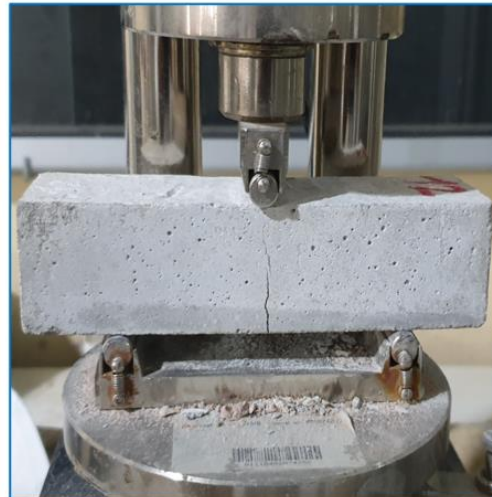
Figure III-18 : Matériels utilisés et essai de traction par flexion trois points.
