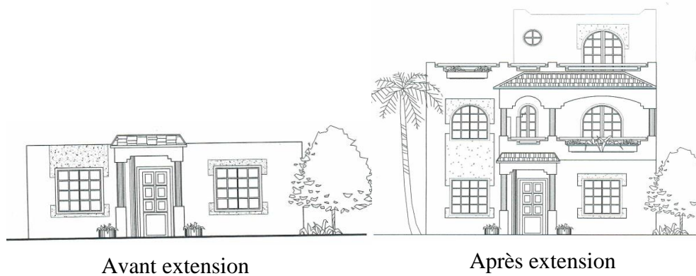
Figure V-25 : Conception proposé de façade de logement Type B (Source : Commune d'ain Smara, 2021)
