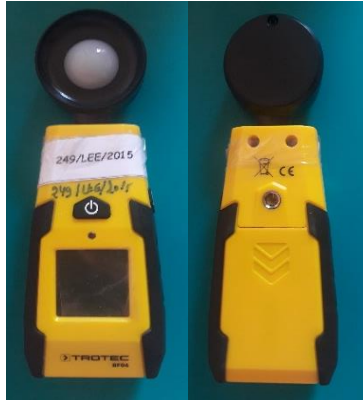
Figure VIII-2: Luxmeter pour la mesure de l'éclairage (Source : Auteur, 2021)
