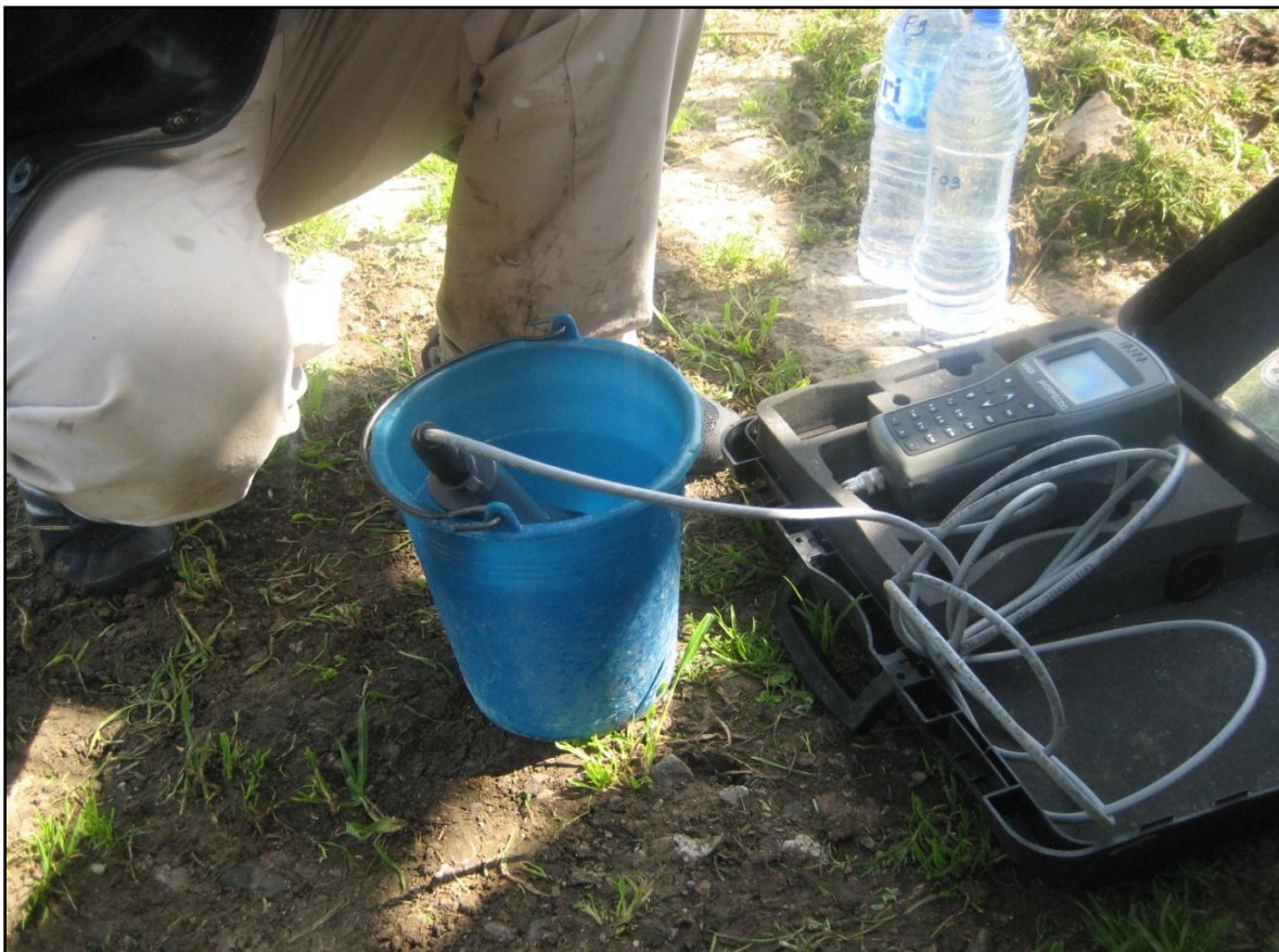
Fig.16: Analyse des paramètres physiques à l'aide d'un multi-paramètre sur le terrain.
