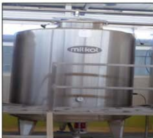
Photo.7. Tank de stockage du lait
