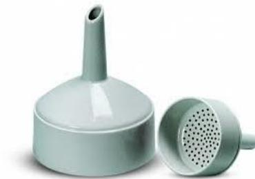
**Figure 6 :** Le filtre de type 'Büchner'.
