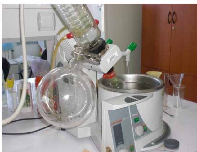
Figure III.1: Évaporateur rotatif (LABOROTA 4000-Efficient Heidolph).
