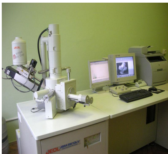
Figure III.14: Microscope électronique à balayage MEB (JEOL JSM-5610LV) [25].
