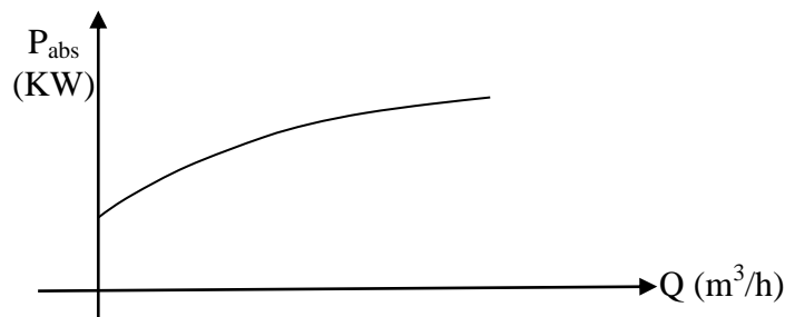
Fig. (3.2) : Puissance absorbée en fonction du débit
