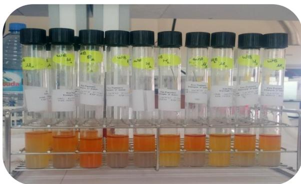
Figure 43 : coliformes fécaux résultats positifs de test confirmatif de la méthode de NPP
