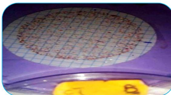
**Figure 41 : Dénombrement des coliformes totaux par la méthode de filtration sur membrane (Avril 2015).**
