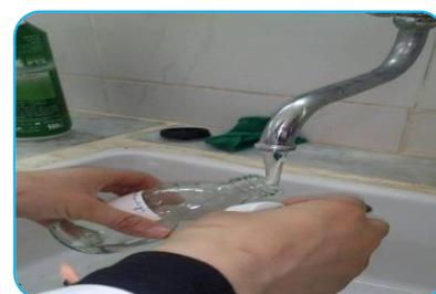
**Figure 06 : Mode de prélèvement d'eau à partir d'un robinet.**
