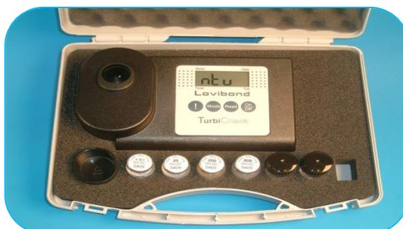
Figure 08 : Turbidimètre.
