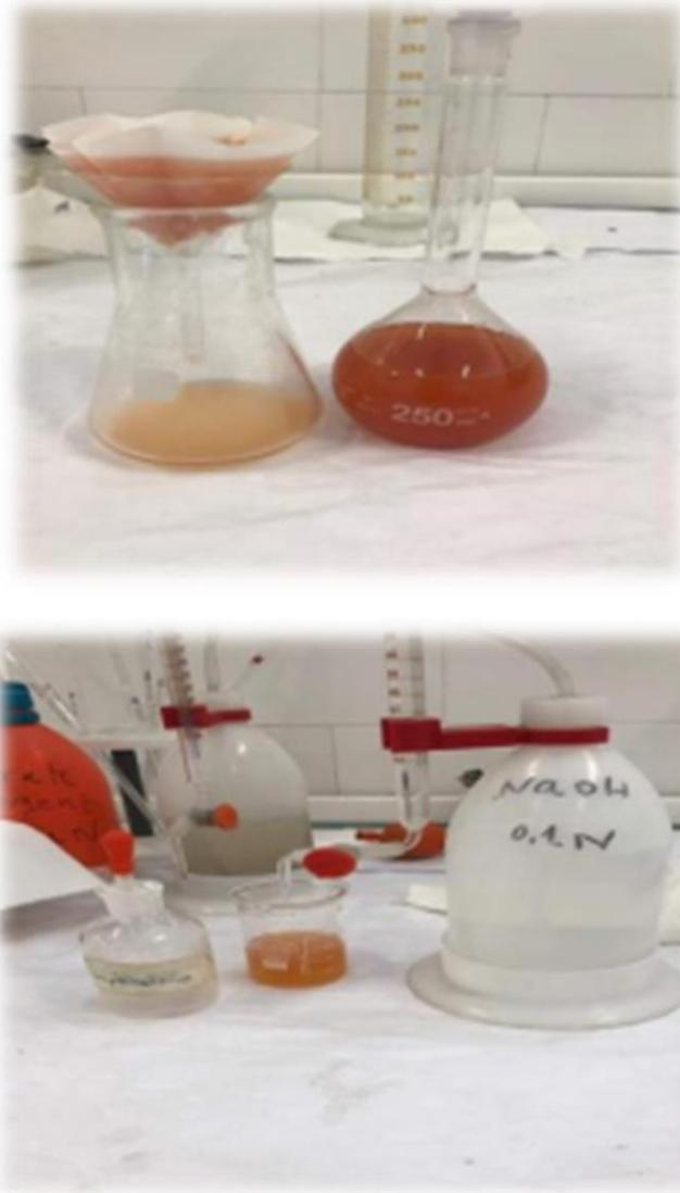
**Figure 16** : Filtration et titrage avec NaOH. (Photo prise par Merabet F Zahra 06-02-2023)
