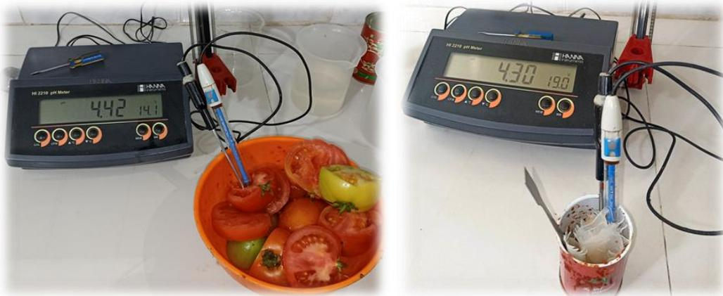
**Figure 13 :** pH-mètre de paillasse avant et après conservation. (Photo prise par Merabet F Zahra 06-02-2023)
