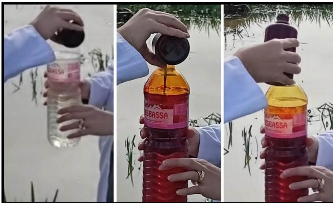
**Figure 06** : Représentation de la méthode de la fixation avec Lugol (Bouleghiout *et al.*, 2023).
