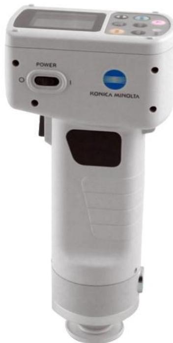
Figure 8 : Colorimètre Konica Minolta modèle CR-410 (laboratoire pédagogique, université 8 Mai 1945, Guelma)
