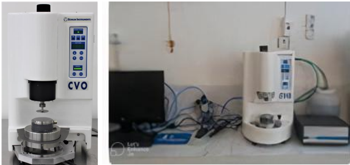
Figure 9 : Rhéomètre dynamique CVO-100-901 (laboratoire d'Analyses Industrielles et Génie des Matériaux (LAIGM), université 8 Mai 1945, Guelma)
