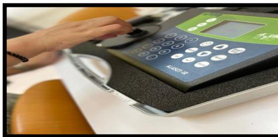
**Figure 34 :** mesure de la turbidité (AL450T-IR)
