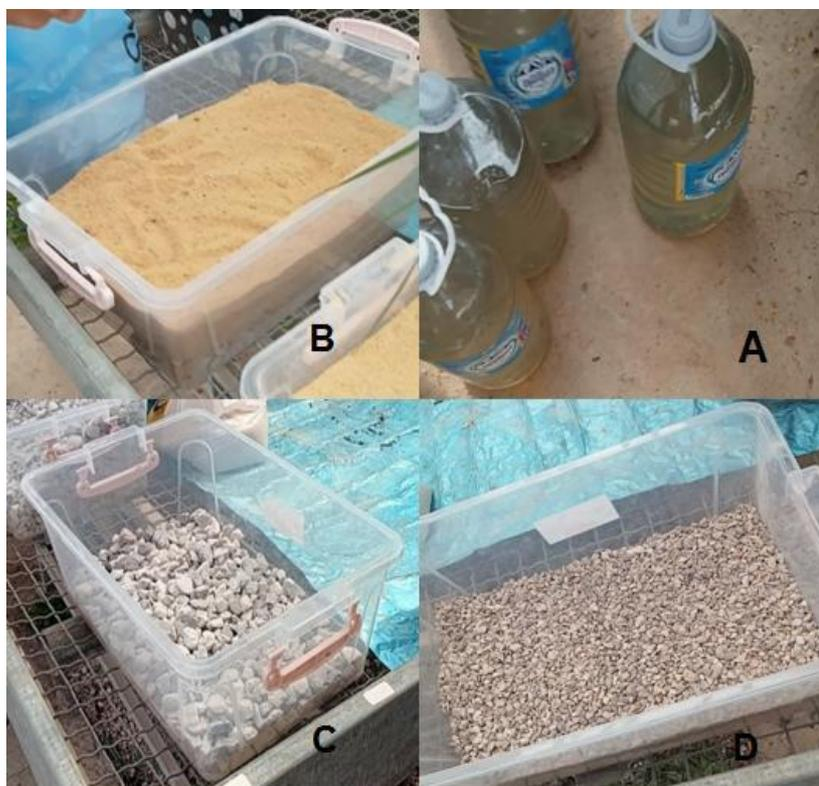
**Figure 15** : Composition du dispositif expérimental. A: échantillons d'eau usée ; B: couche de sable ; C: couche de gravier grossier ; D : couche de petit gravier
