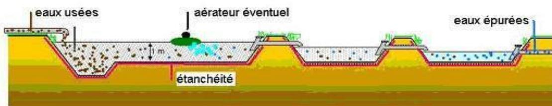
**Figure 3:** Coupe schématique d'une station à lagunage (**Karaali et al., 2008**).
