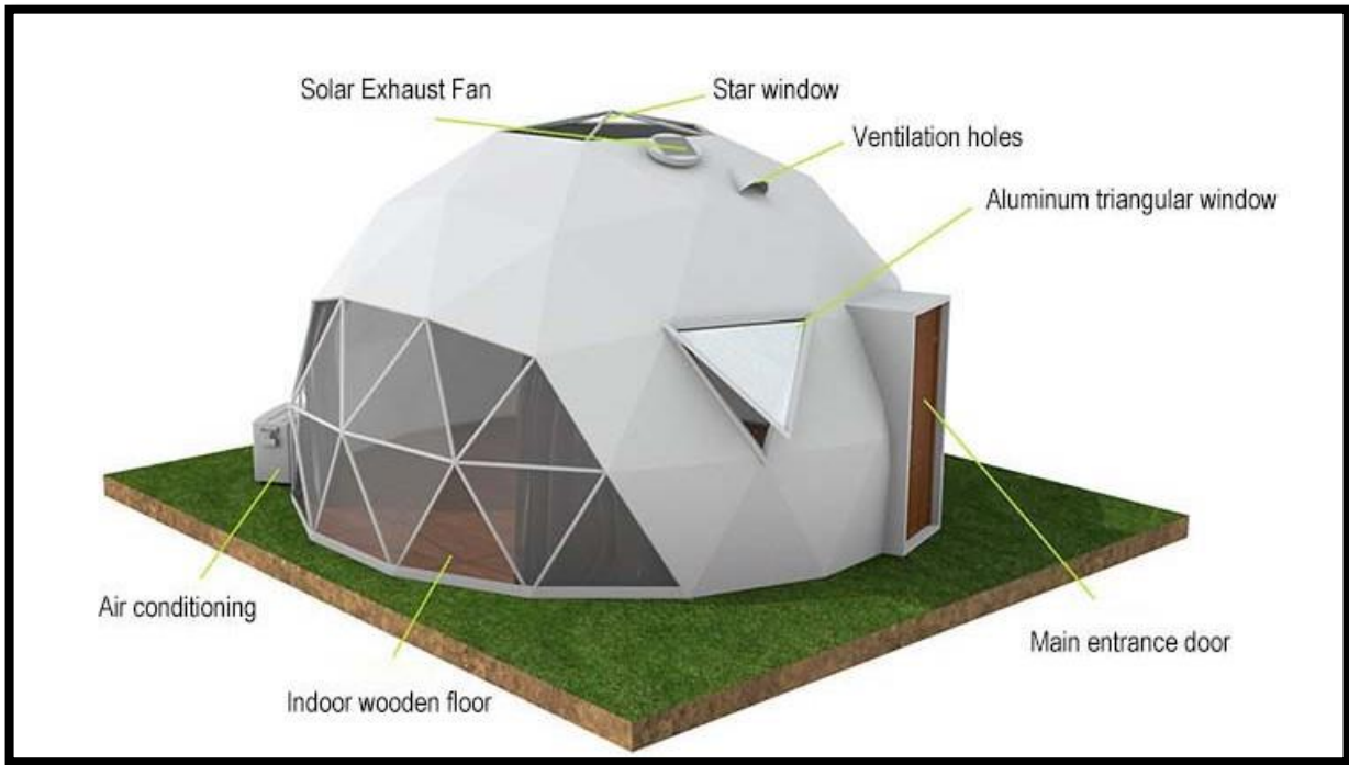
شكل 2 المكونات الخارجية والداخلية للخيمة الجيوديسية
