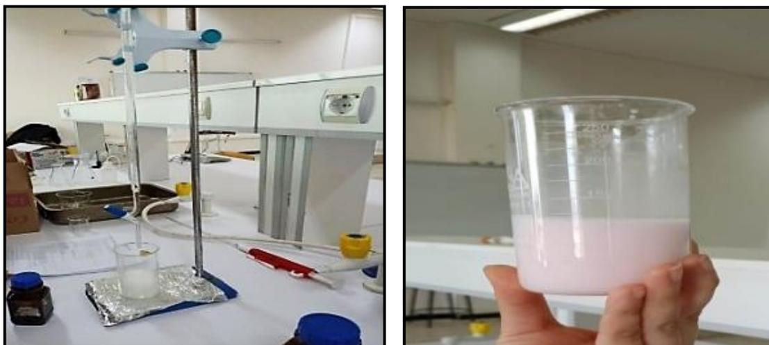
**Figure 8.** Détermination de l'acidité de yaourt/fromage par titrage à l'aide d'hydroxyde de sodium.
