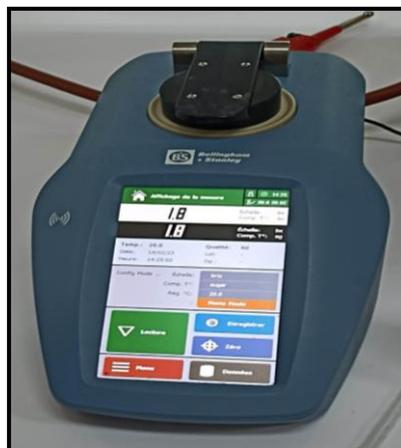
**Figure 12.** Réfractomètre utilisé en mesure d'indice de réfraction et d'indice Brix.
