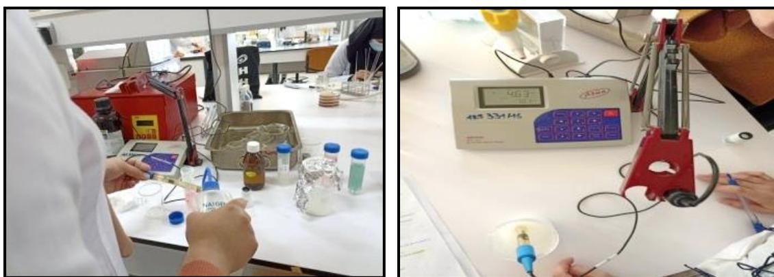
**Figure 7.** Mesure du pH des échantillons analysés à l'aide d'un pH-mètre (type HANNA pH 2211).
