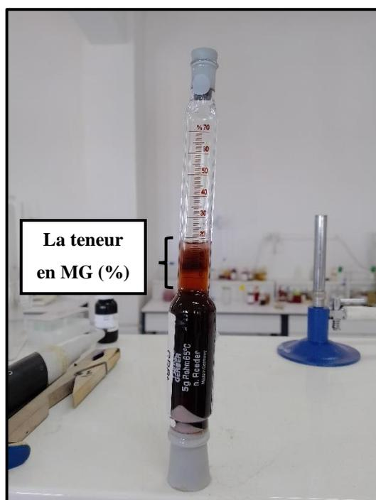
**Figure 10.** Détermination de la matière grasse de fromage fondu à l'aide d'un butyromètre de Gerber
