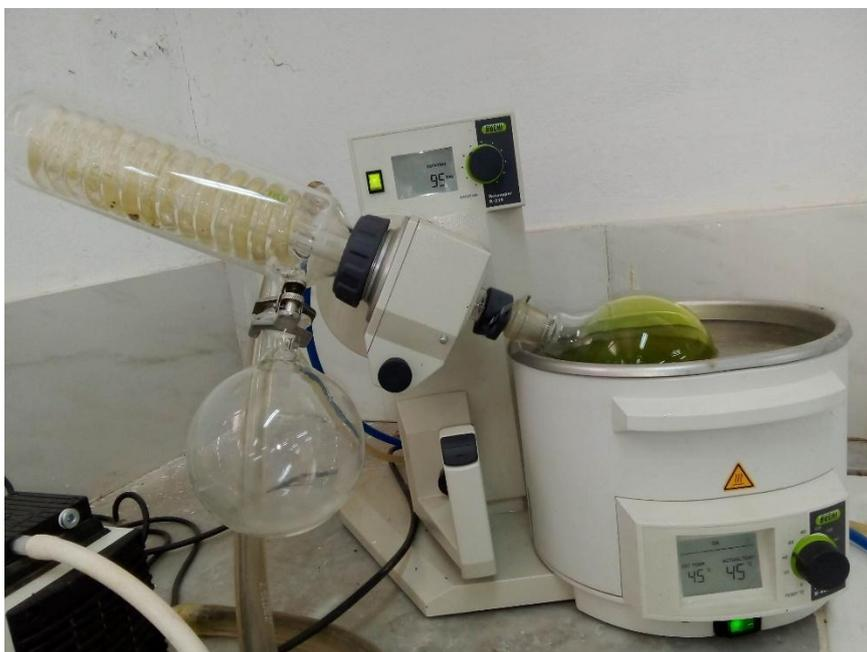
**Figure :** extraction méthanolique l'aide d'un évaporateur rotatif (Büchi Rotavapor R-215)
