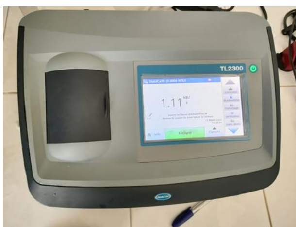
Figure.II.3 : Image du turbidimètre utilisé.
