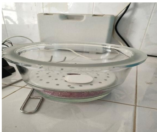
Figure. II.13 : Images des accessoires pour la détermination du résidu sec (RS).
