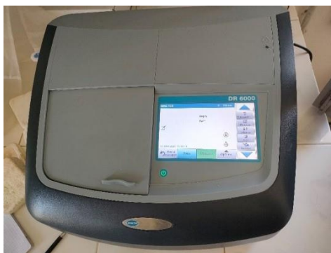
Figure. II.16 : Schéma d'un Spectrophotomètre servant au dosage de ( \text{Fe}^{2+} )
