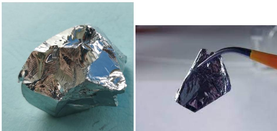
FIGURE 2 – Le séléniure de molybdène  $\text{MoSe}_2$  , Le séléniure de tungstène  $\text{WSe}_2$  sous forme monocristalline .
