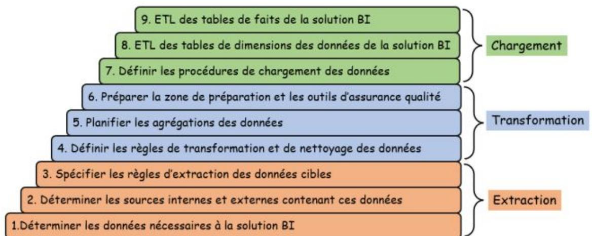
FIGURE 1.3 – Enchaînement général des opérations du processus ETL d'après [14]
