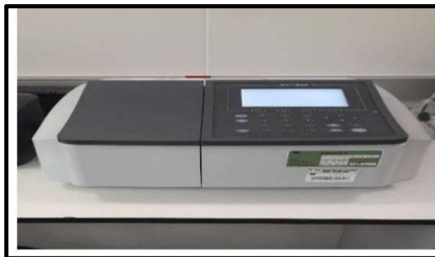
Figure 38. Spectrophotométrie d'absorption d'infra rouge.
