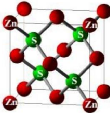
Figure II.3 : Représentation schématique de la structure Zinc Blende (B3).
