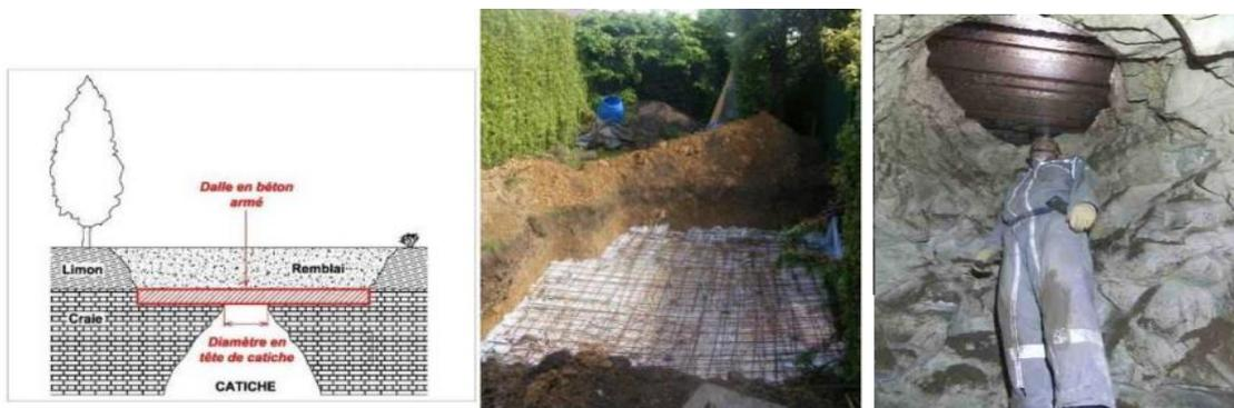
Figure VI.25 Renforcement anciens puits
