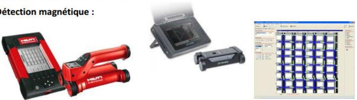
Figure VI.8 Méthode de détection magnétique des armatures
