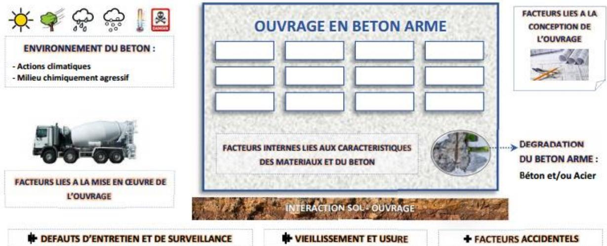
Figure II.1 Origines des désordres et dégradations dans les ouvrages en Béton Armé (BA).
