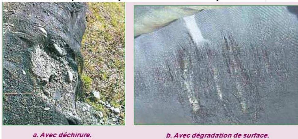
**Figure V.40** Exemples de dégradations de nappes de géotextiles non protégées : déchirures et altération des fibres.
