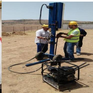
Figure I.6 Essai in-situ Détermination de résistance du sol par pénétration dynamique lourde.
