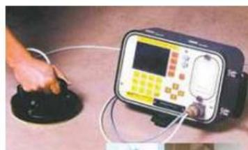
Mesures de vitesse de corrosion
