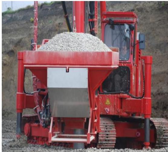
Figure VI.36 Colonnes ballastées
