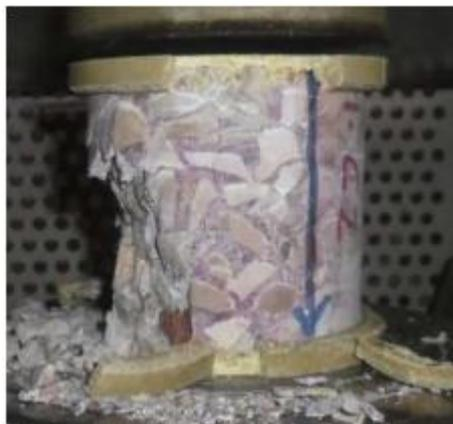
**Figure VI.12** Essai d'écrasement sur une carotte.
