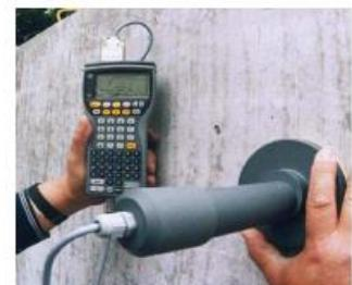
Figure VI.10 Méthode de mesure électrochimique des armatures.
