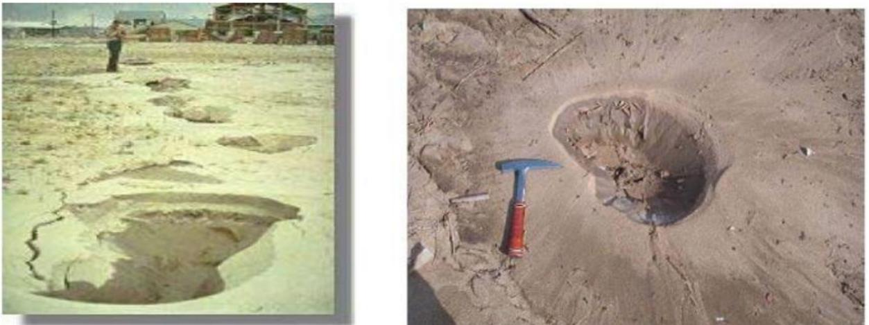
**Figure III.24** Ebullition de sable.
