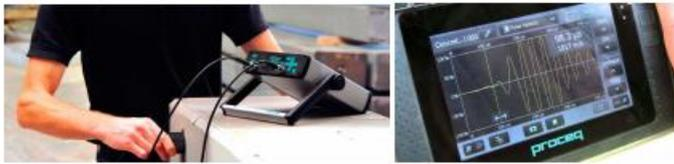
**Ausculteur sonore** : mesure la vitesse du son dans le béton pour en évaluer la résistance (NF EN 10250-4)
