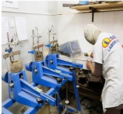
Figure I.5 Essai œdométrique au laboratoire.
