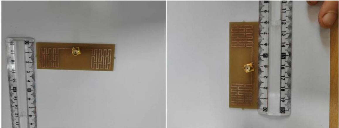
Figure III.20: Antenne dipôle fractale de Peano à l'itération 2 bi-bande réalisée.
