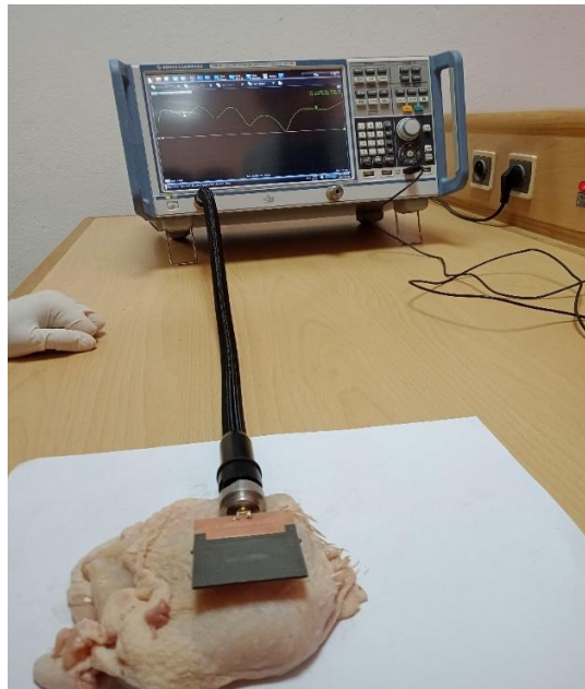
Figure 3.20 : Mesure de coefficient de réflexion pour la détection des tumeurs.
