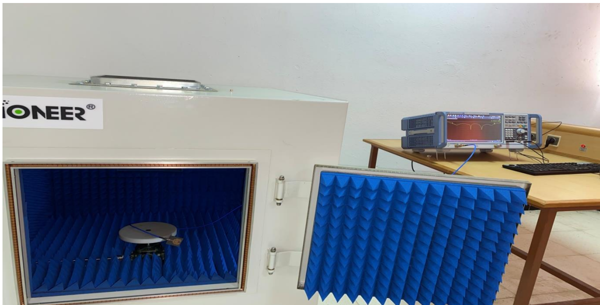
Figure 3.11 : Mesure de coefficient de réflexion dans la chambre anéchoïque.
