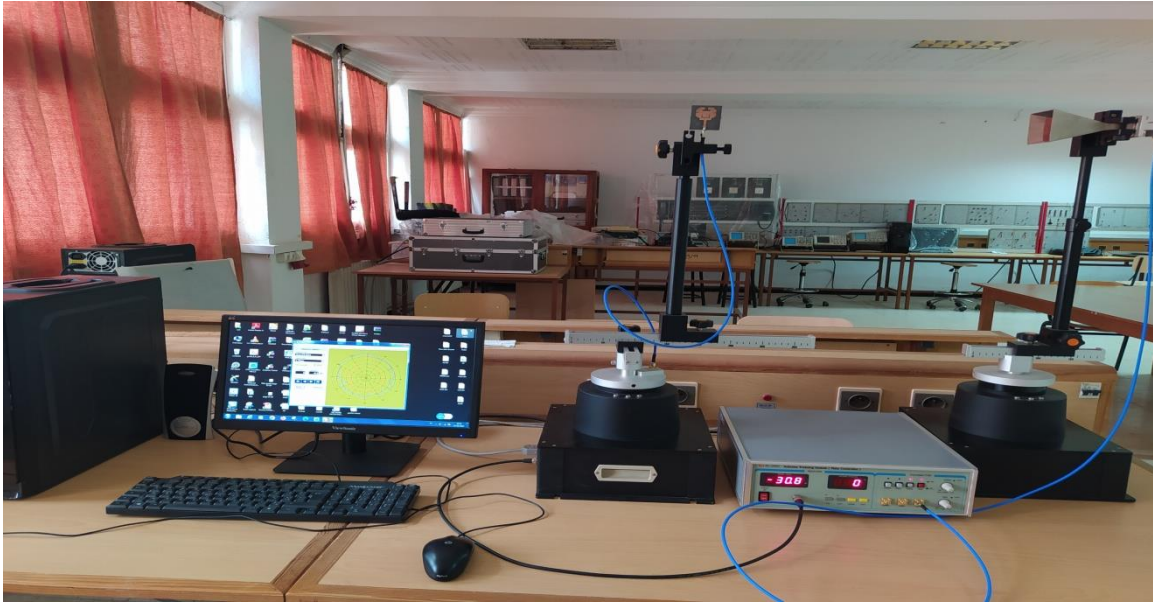
Figure 3.17: Banc de mesure de diagramme de rayonnement.
