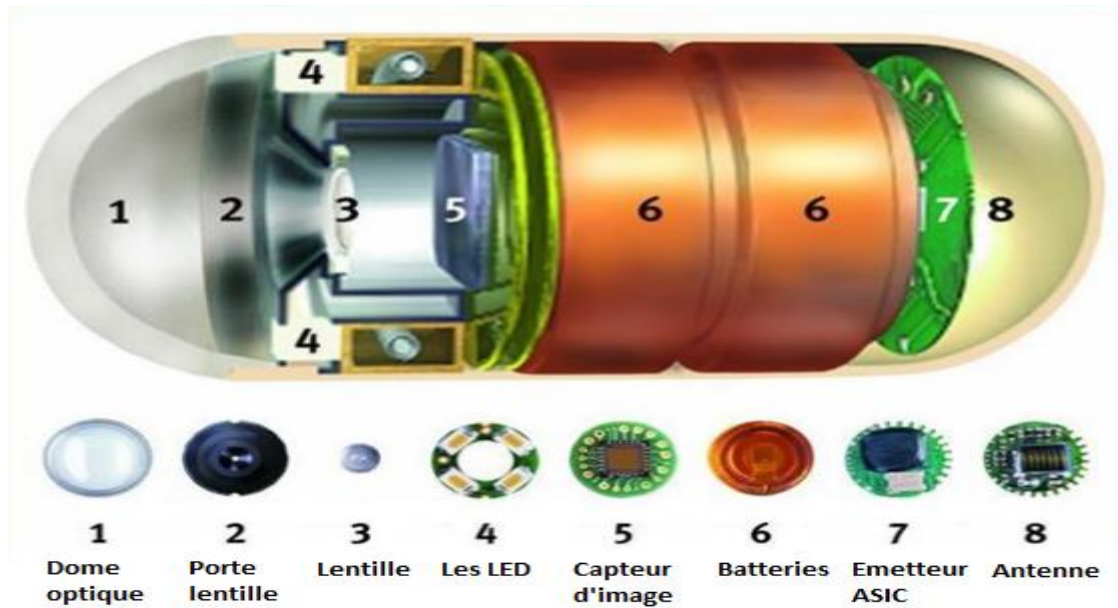
Figure 2.7 : Structure de la capsule endoscopique [49].
