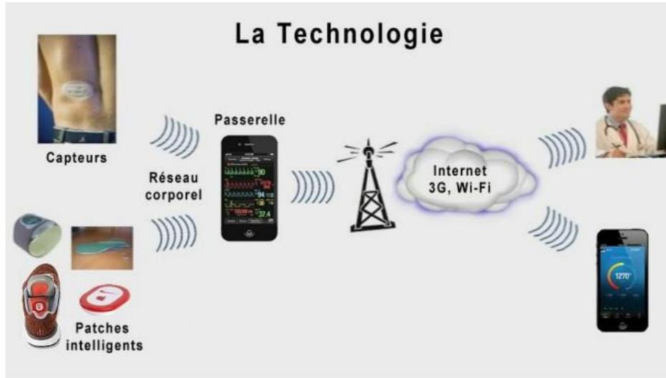
FIGURE 2.5 – Un système de bio-télémetrie numérique sans fil qui surveille les signes vitaux à l'aide d'un téléphone intelligent [40].
