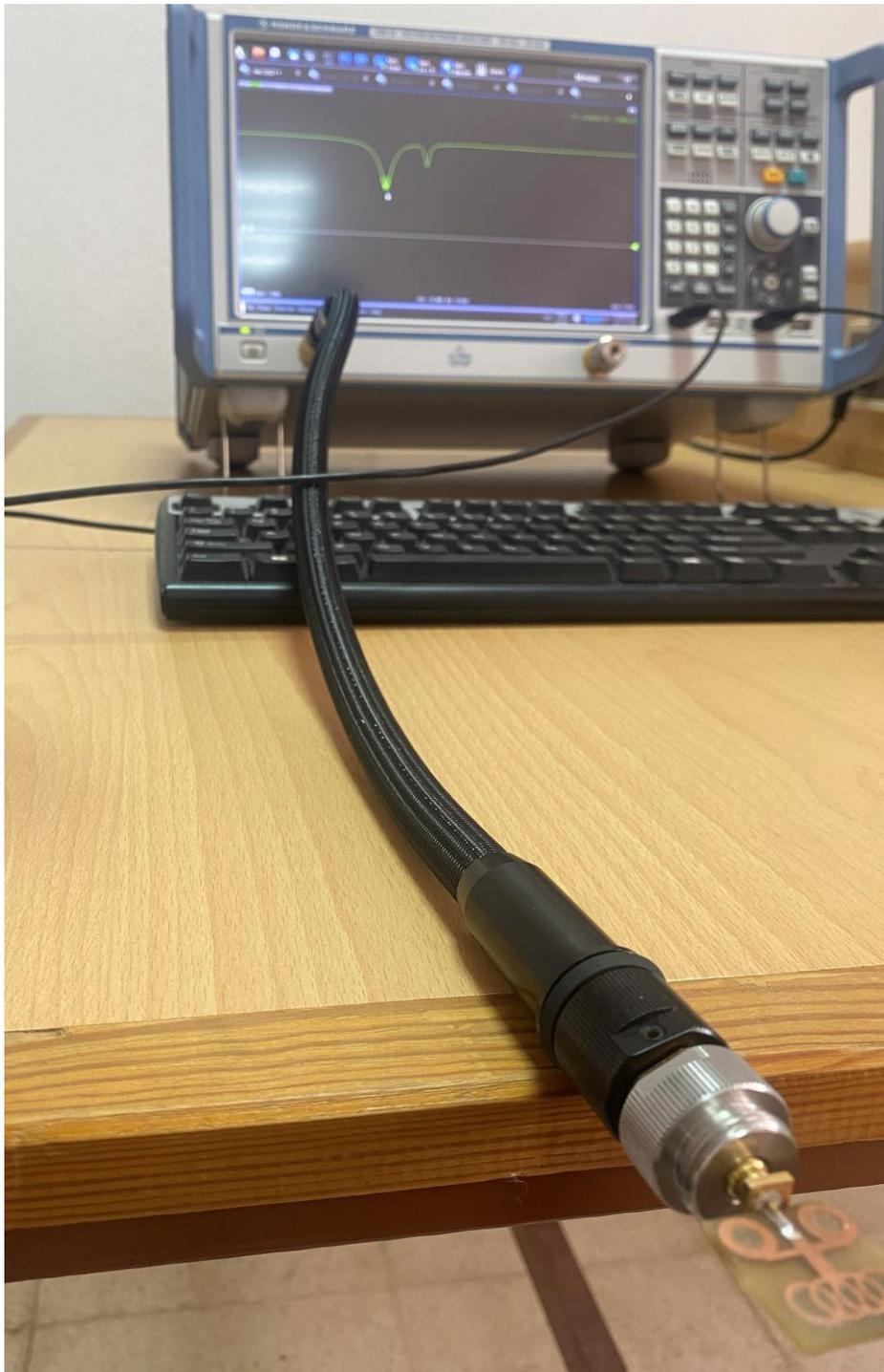
FIGURE 3.20 – Antenne réalisé sur l'analyseur de réseau vectoriel ZNB20
