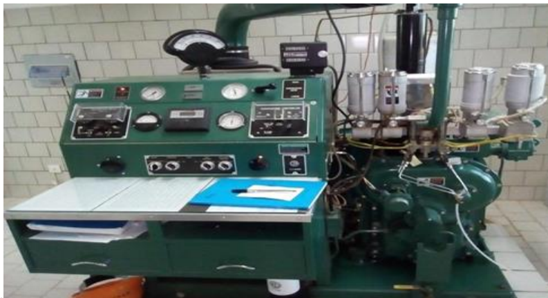
Figure II.16: Photo montrant le moteur C.F.R.
