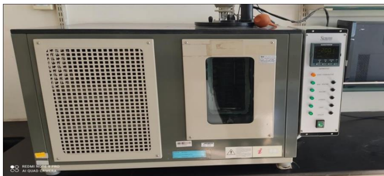
Figure II.7 :Viscosimètre de type SCAVIN [ASTM D445].
