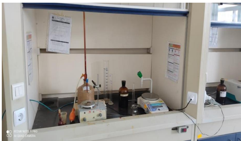
Figure II.13 : Mesure de l'acidité.
