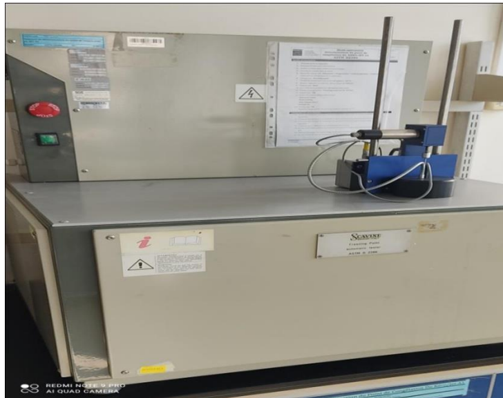
Figure II.11 :Appareil pour la détermination du point de congélation.
