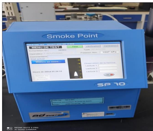
Figure II.12 : Appareil pour mesure du point de fumée.
