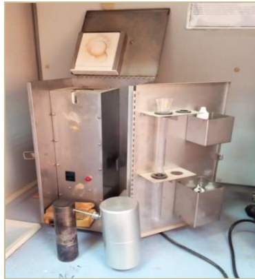
Figure III. 7 : Distillateur de fluides de forage [63].
