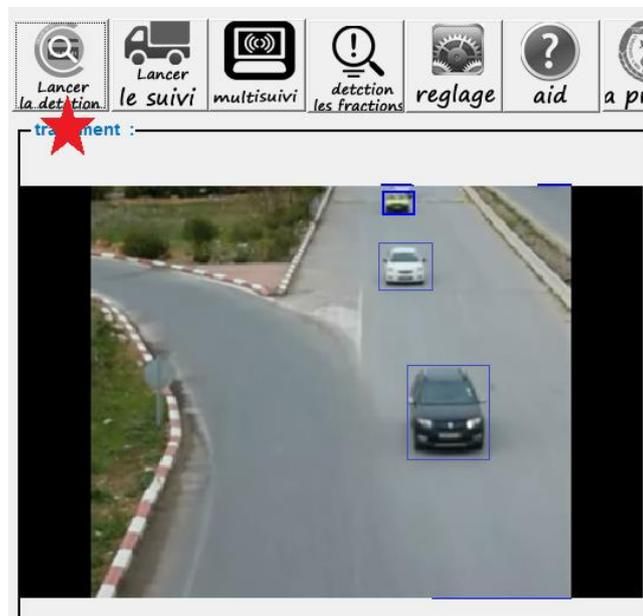
Figure IV.13: Détection les véhicules en rectangle bleu(mesuré).
