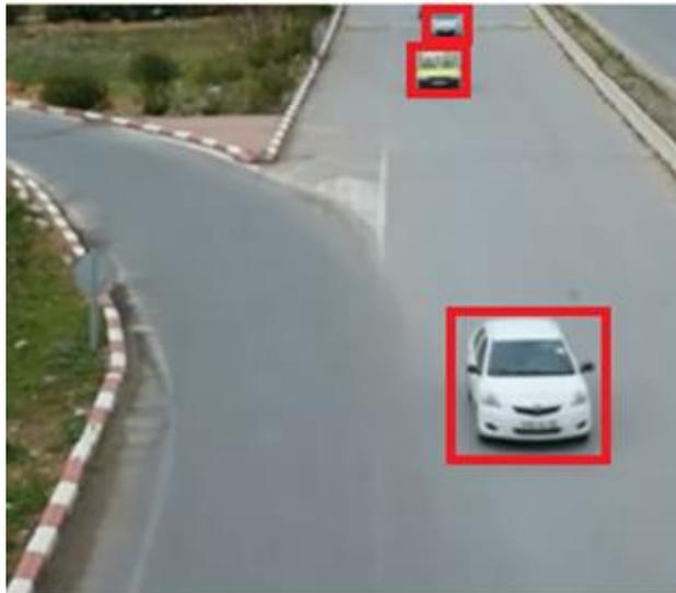
*Figure IV.9 : Exemple d'application du filtre kalman sur le suivi de trois véhicules.*
