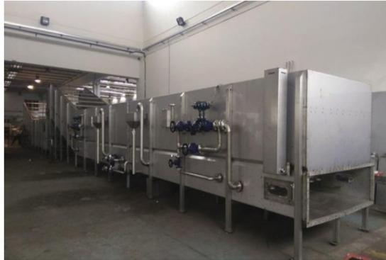
**Photographie I.10:** Tunnel de stérilisation et de refroidissement de la purée de harissa.
