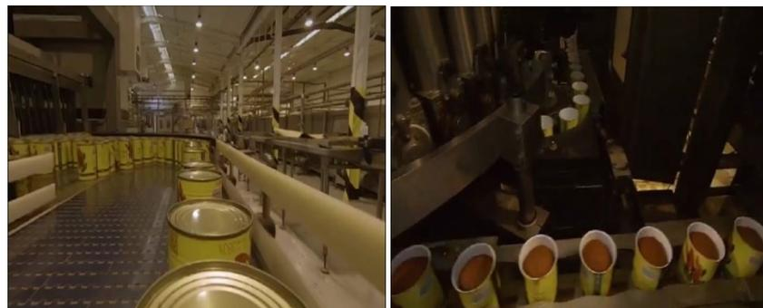
**Photographie I.9:** Remplissage et sertissage des boîtes.
