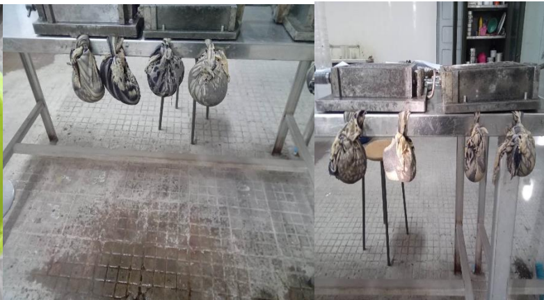
Figure III.16 : Filtration du déchet du marc de café pendant 10 minutes.
