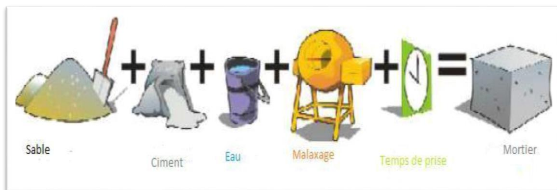
Figure I.2: Composition d'un mortier. [5]
