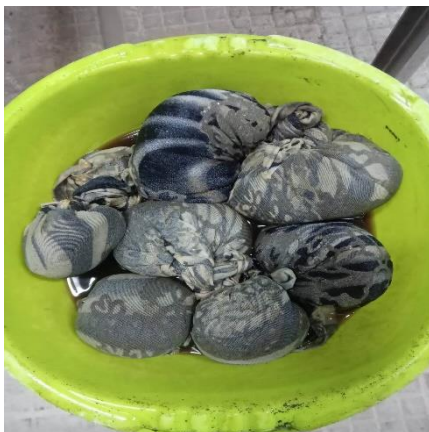
Figure III.15 : Stabilisation du déchet du marc de café 24h à l'eau.
