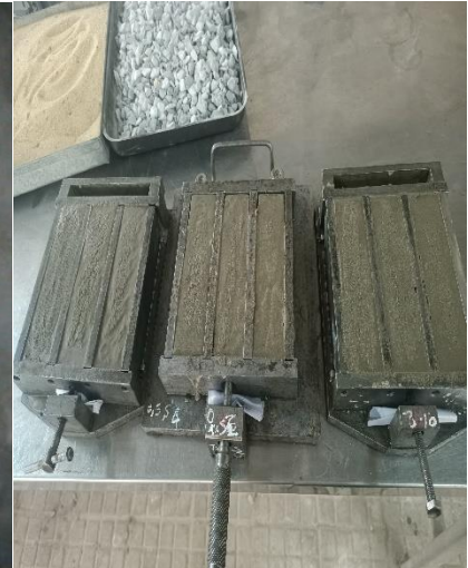
Figure III.23 : Dernière vibration et rasage.
