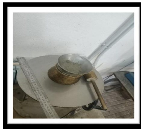
Figure III.17 : Un essai d'étalement.
