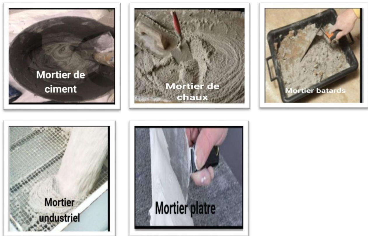
Figure I.7 : Les types de mortiers. [15]
