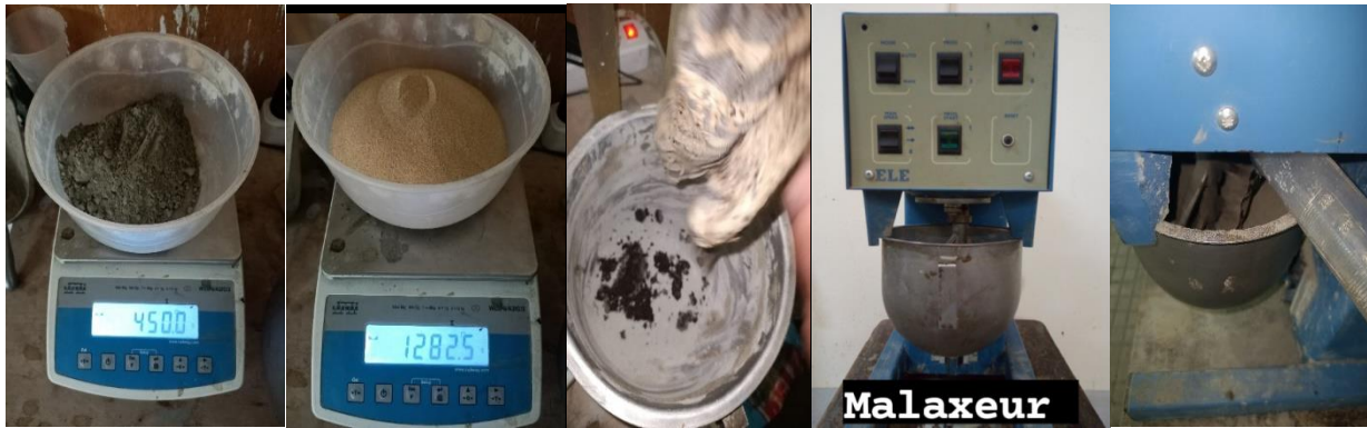
Figure III.19: Les étapes pour préparer la pâte (sable de dune) avec différent pourcentage de déchet du mac du café.
