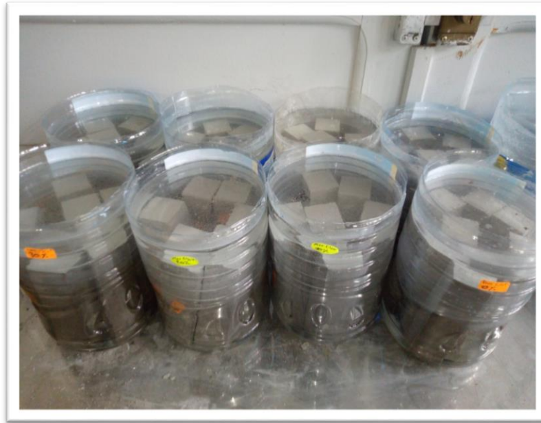
Figure III.25: Cure des éprouvettes à l'eau pendant 28 jours.
