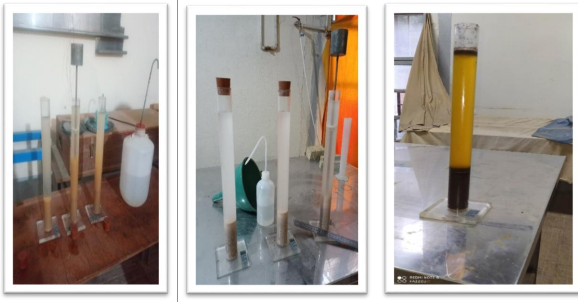
Figure III.9: Résultats d'essais d'équivalent des deux sables et du déchet utilisé.
