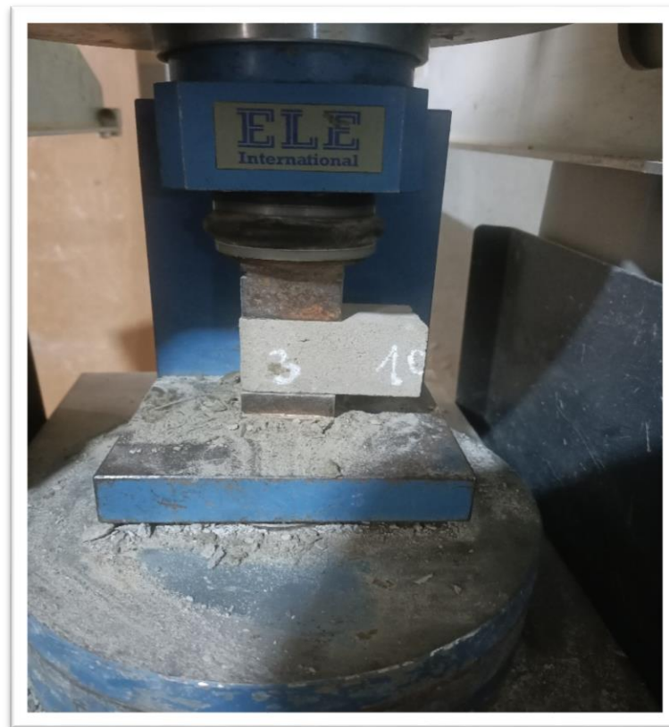
Figure IV.11: L'essai de résistance à la compression.
