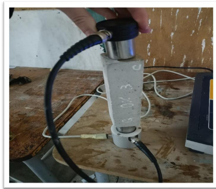
Figure IV.13 : Mesure de la vitesse de propagation de sons sur des éprouvettes prismatique (4×4×16) cm 3 .
