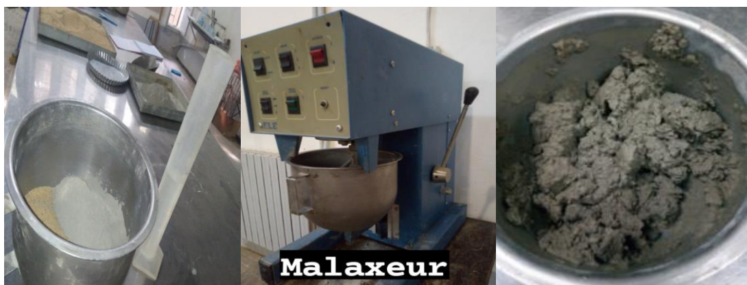
Figure III.18: Les étapes pour préparer la pâte de mortier témoin (0% MC).
