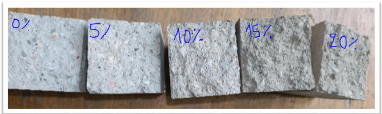
Figure IV.9: Distribution de différent pourcentage de déchet de marc de café (sable de carrière)
