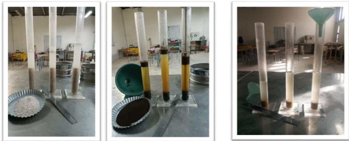
Figure III.8: Essai de la masse volumique absolue des deux sables et du marc de café utilisés.
