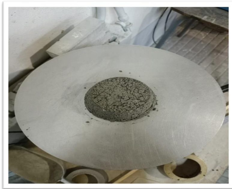
Figure III.14 : Résultat d'un étalement raide.
