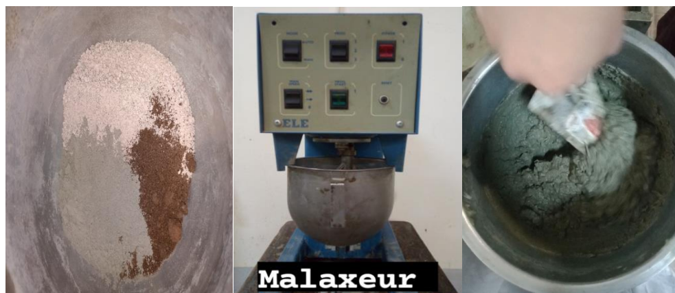
Figure III.20: Les étapes pour préparer la pâte (sable de carrier) avec différent pourcentage de déchet du mac du café.
