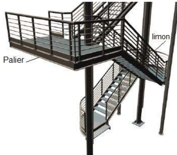
Figure IV. 1 : Escalier en charpente métallique.
