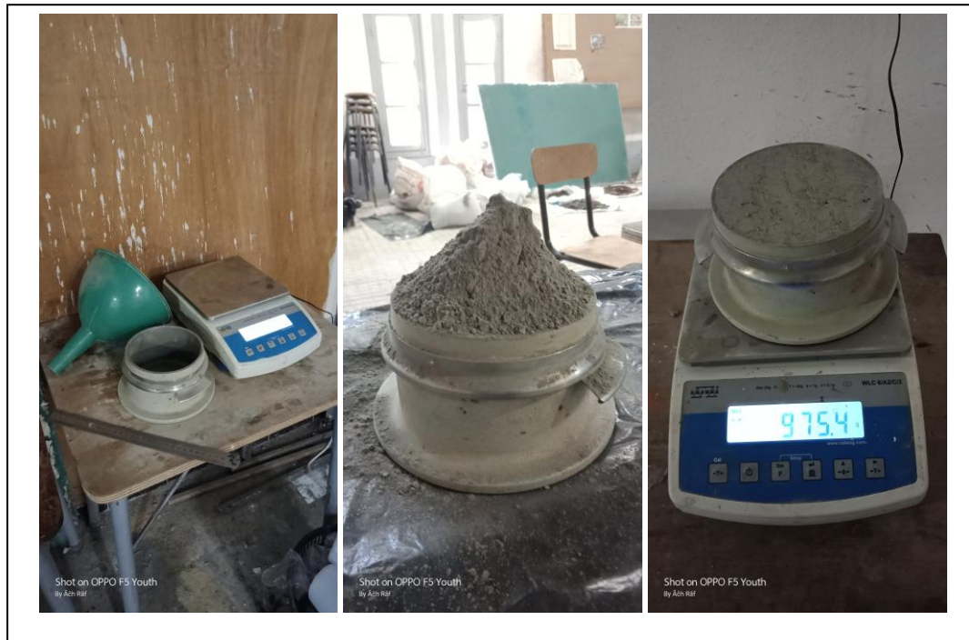
Figure 2.9 : Masse volumique apparente des ciments anhydres.
