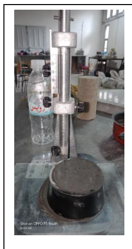
Figure 2.11 : Appareil de Vicat.
