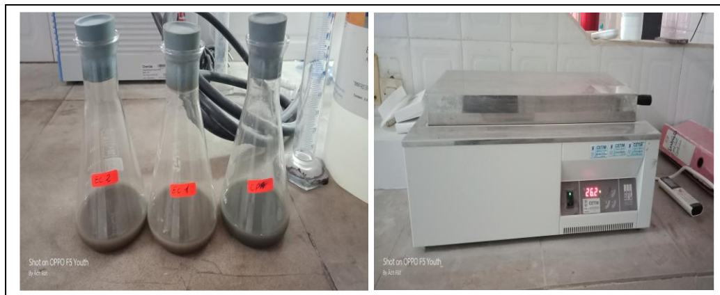
Figure 2.7 : Essai de la teneur en CaO libre.
