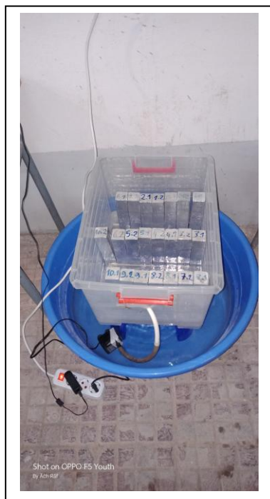
Figure 2.19 : Essai d'absorption d'eau par capillarité.
