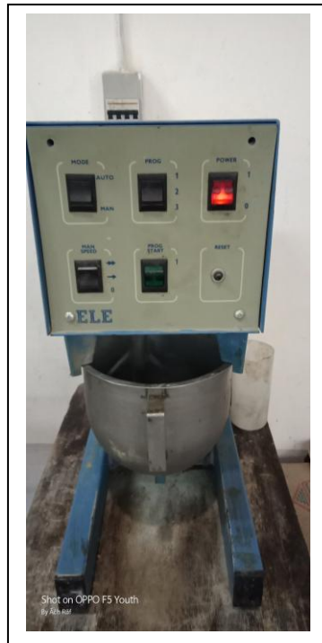
Figure 2.3 : Malaxeur pour la préparation du mortier normalisé.
