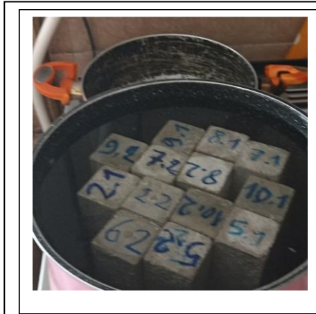
Figure 2.17 : Etude de la porosité accessible à l'eau selon la norme Américaine ASTM C642.
