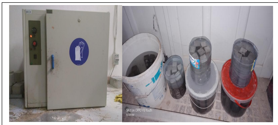
Figure 2.15 : Etuve utilisée - Conservation des éprouvettes à l'eau potable.
