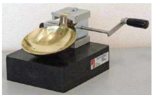
Figure III 4 : L’appareil de casa grande.
