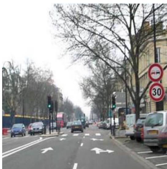
Figure III 27 : Flèche de section
