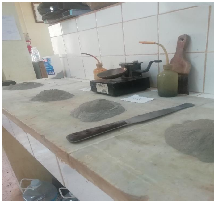
Fig.4-6 la coupelle de Casagrande pour la détermination de la limite de liquidité
