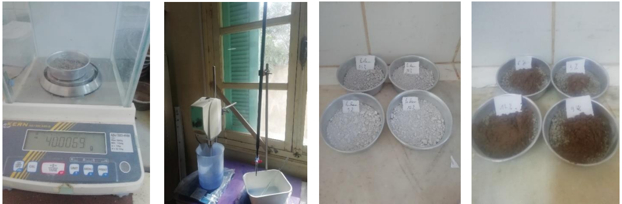
fig 4-14 Traitement du sol pour déterminez la Valeurs de VBS pour sol non traite et traite avec la chaux et la poudre du déchet d'olive.
