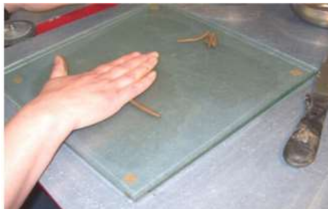
Fig 3-14 Images présentant le mode opératoire de la limite de plasticité W_p .
