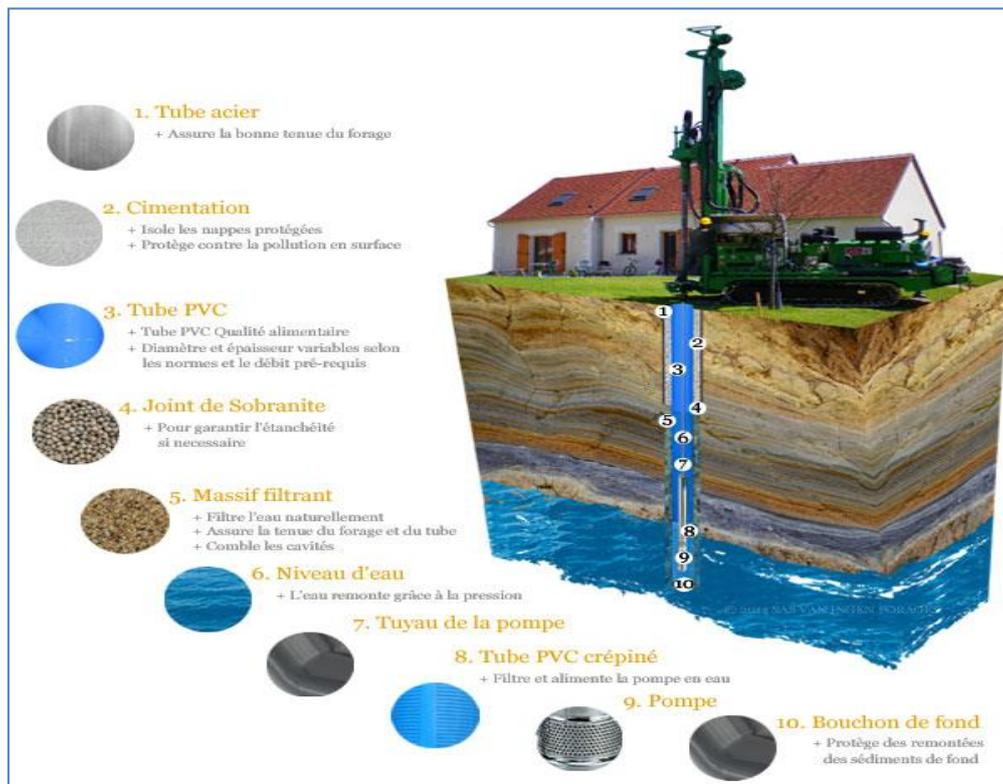
Figure (2.3) : coupe technique d'un ouvrage profond type
