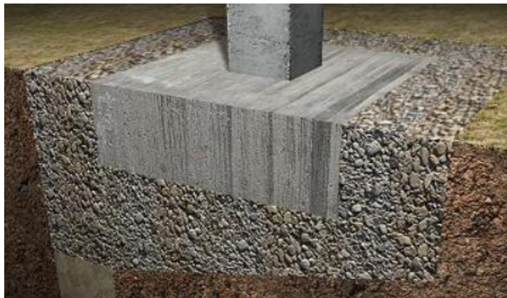
Figure II.17 Remblai de grave sous fondation
