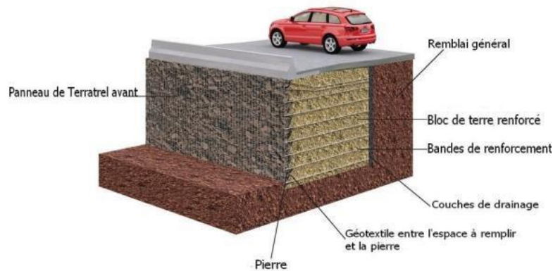
Figure I.3 Mur en terre armé
