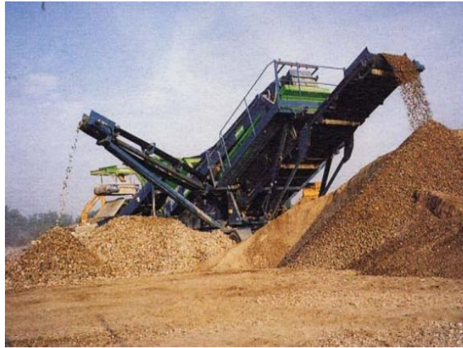
Figure II.15 Matériaux de béton recyclé en production
