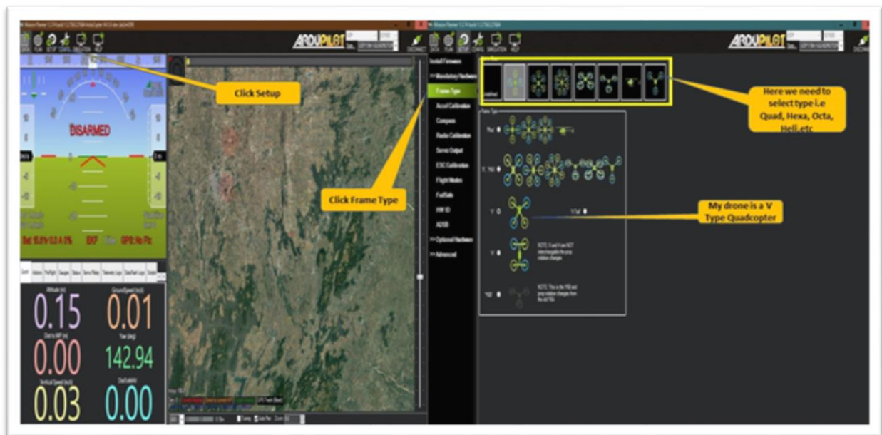
Figure 41: Configuration du châssis
